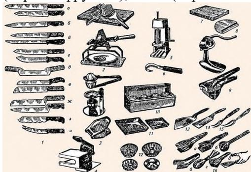
Инвентарь и приспособления, используемые в холодном цехе: 7 - доска разделочная; 8 - доска для нарезки лимонов; 9 - соковыжималки ручные; 12 - формы для сладких блюд; 16 - приборы для раскладывания блюд: а, б, в - приборы салатные; г - прибор для консервированных фруктов; д - щипцы для раскладывания порционных блюд.
