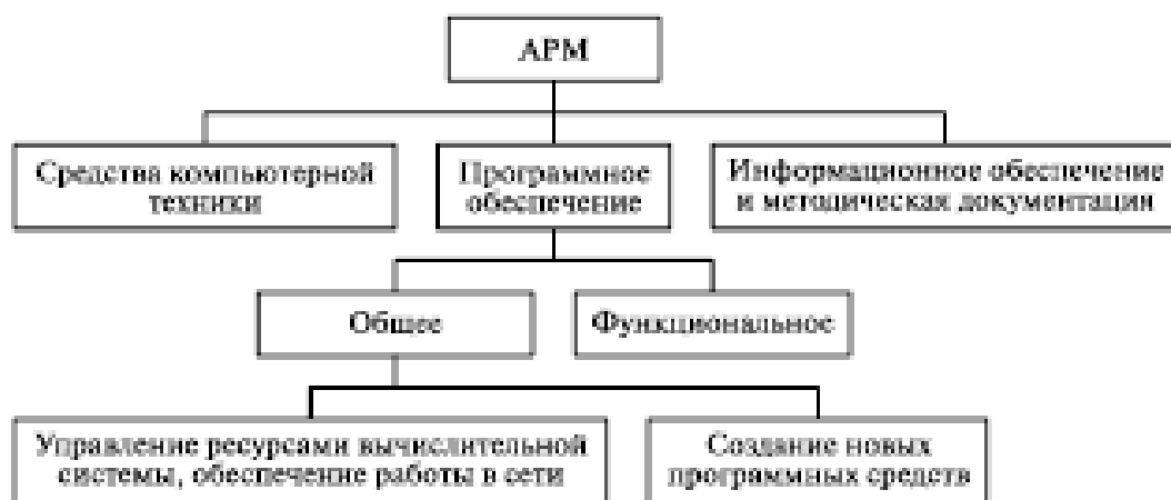
Рис. 1.1. Структура автоматизированного рабочего места специалиста
