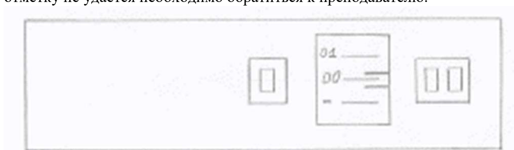
Рис.2 Отсчетный экран весов ВЛР-200 при установлении нулевой точки весов
